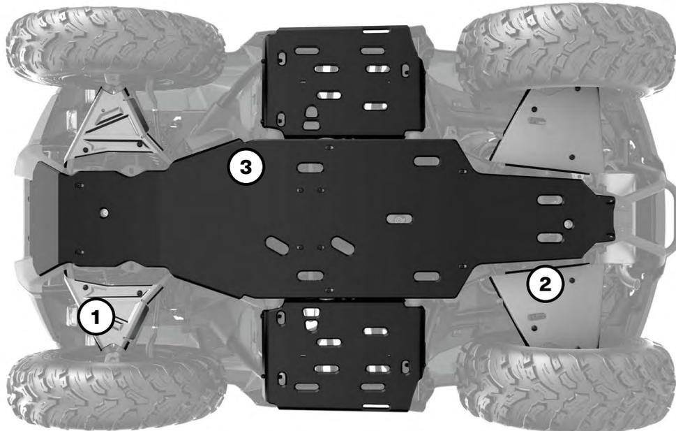
Nossas Placas de Proteção oferecem durabilidade, resistência e confiabilidade que suas aventuras precisam. Proteja a parte inferior do seu veículo da frente até a traseira, com as bordas dobradas na área dos pés para proteção extra. Eles combinam materiais para proteção máxima: dos braços em A em alumínio e a placa inferior em plástico, seu veículo pode passar por em terrenos acidentados com confiança.
