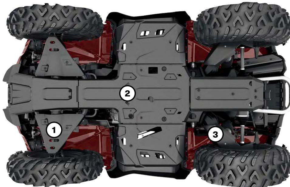
Nossas placas de plástico deslizam de forma suave e silenciosa sobre os obstáculos, oferecendo excelente proteção em terreno acidentado. Feitas de polietileno de alto peso molecular termoformado (HMWPE) resistente à abrasão de 6 mm (¼") de espessura.
