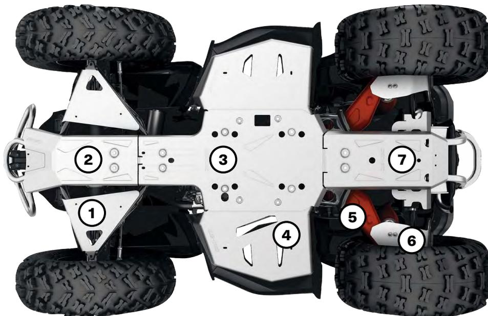
Para máxima durabilidade e resistência, nossas placas de alumínio são feitas de alumínio 5052 H32 de alta resistência com 4,5 mm ( $\frac{3}{16}$ " ) de espessura.
